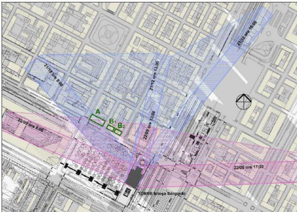
FIGURA 54: Grafico geometrico delle ombre estrapolato dall'atto di assoggettabilità a VIA
